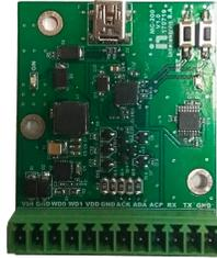
Detalle de la Multi Convertora de Formatos MC-200, gabinete plástico para encastrar con Riel DIN.
